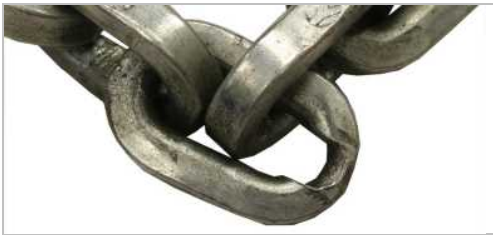
De kettingschakel is sterk versleten.
