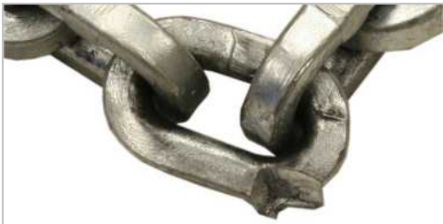
De kettingschakel is mechanisch beschadigd.
